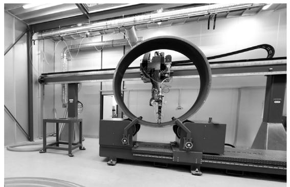
[그림 11] 다이오드 레이저 클래딩 모의시험
