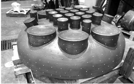
[그림 9] 소형원자로 모의시험 제품 제작을 위한 PM-HIP용 캡슐
