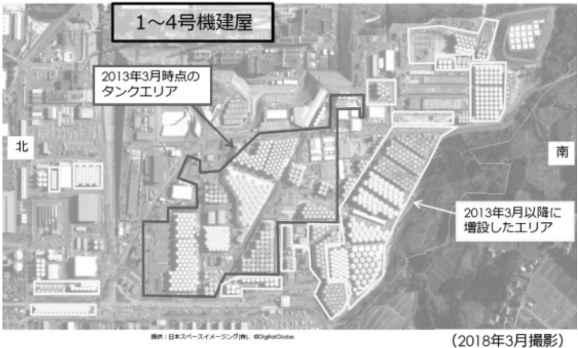
〈그림 3〉 후쿠시마 제1원전 ALPS 처리수 탱크 배치도 (출처: 다핵종제거설비 등 처리수 취급에 관한 소위원회 제13회 회의 자료)
